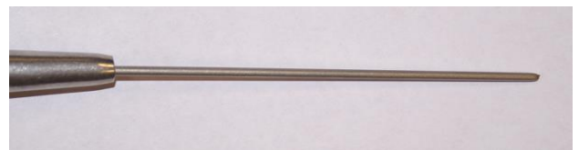
Rupture du fil loin des mâchoires.
