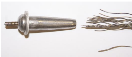
Rupture des câbles à proximité des mâchoires.
